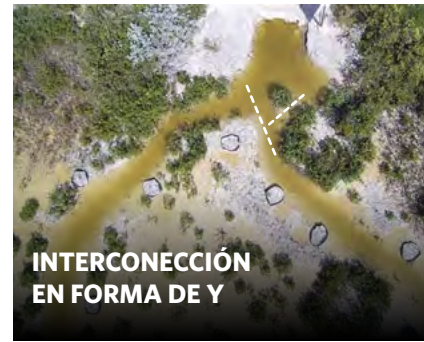
Figura 13. Características estructurales en la rehabilitación de cruces de agua (Teutli-Hernández et al. , 2020).
